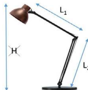
Armaturlampe (bevægelig) Ydre dimension: Den største værdi af L 1 eller L 2 , (ikke værdi H)
